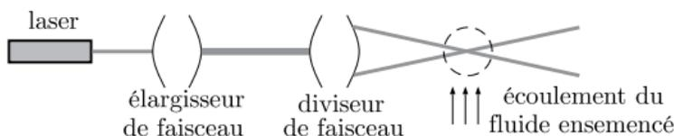
FIGURE 2 – Vue d'ensemble du dispositif
